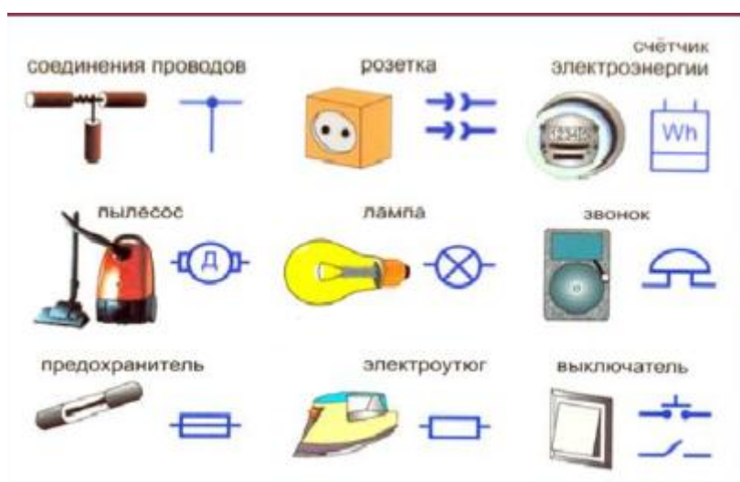
Рисунок 6 – Устройства и их УГО на схемах
